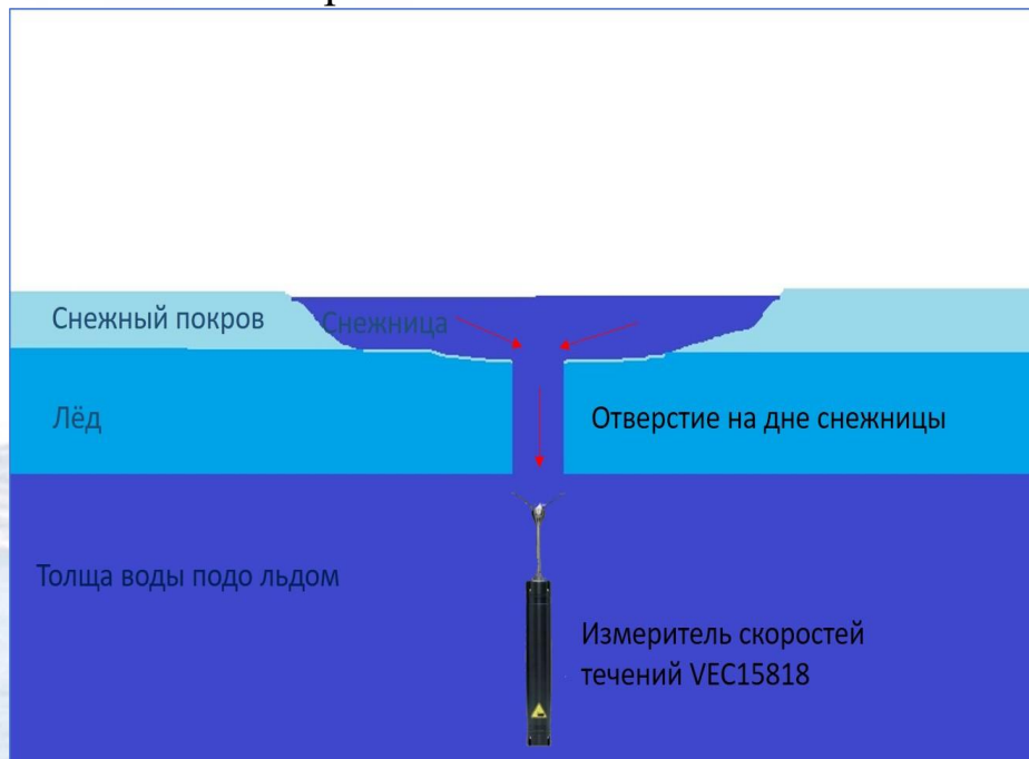
Схематичное изображение эксперимента в вертикальном сечении
