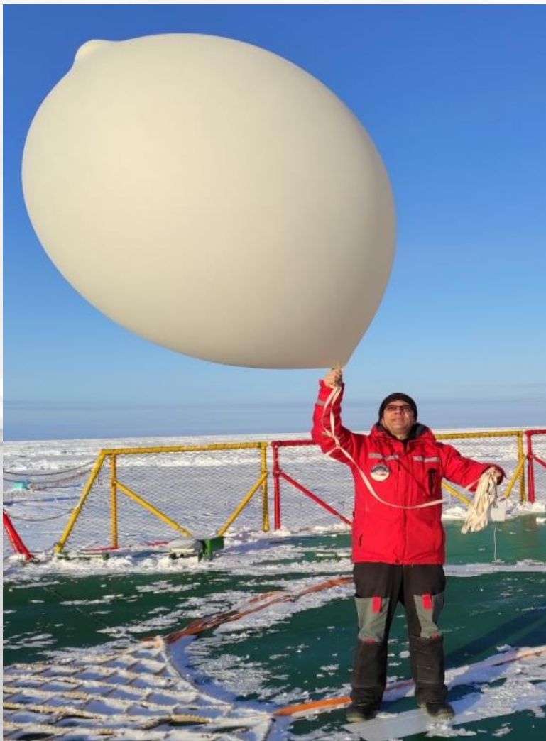
Выпуск аэрологического зонда МРЗ-Н1
