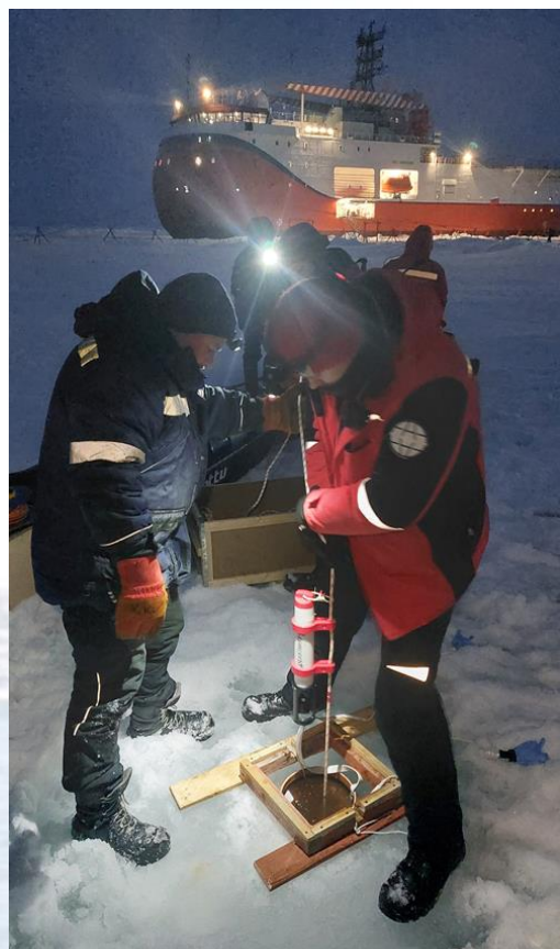
Установка CTD–регистраторов RBR Concerto3 под лед в необогреваемую майну
