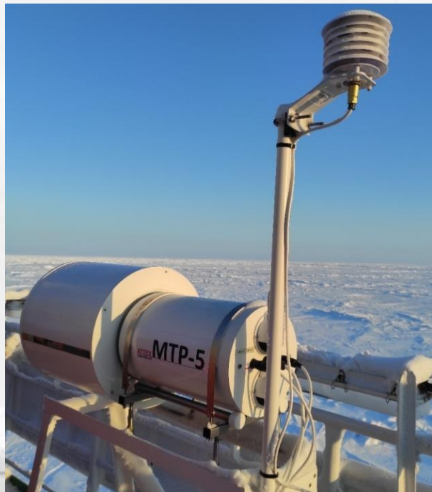
Метеорологический температурный профилемер на борту ЛСП
