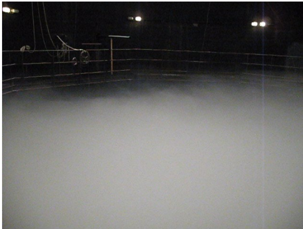
Рис. 3. Воздействие ионного ветра в Большой аэрозольной камере ФГБУ «НПО «Тайфун»
