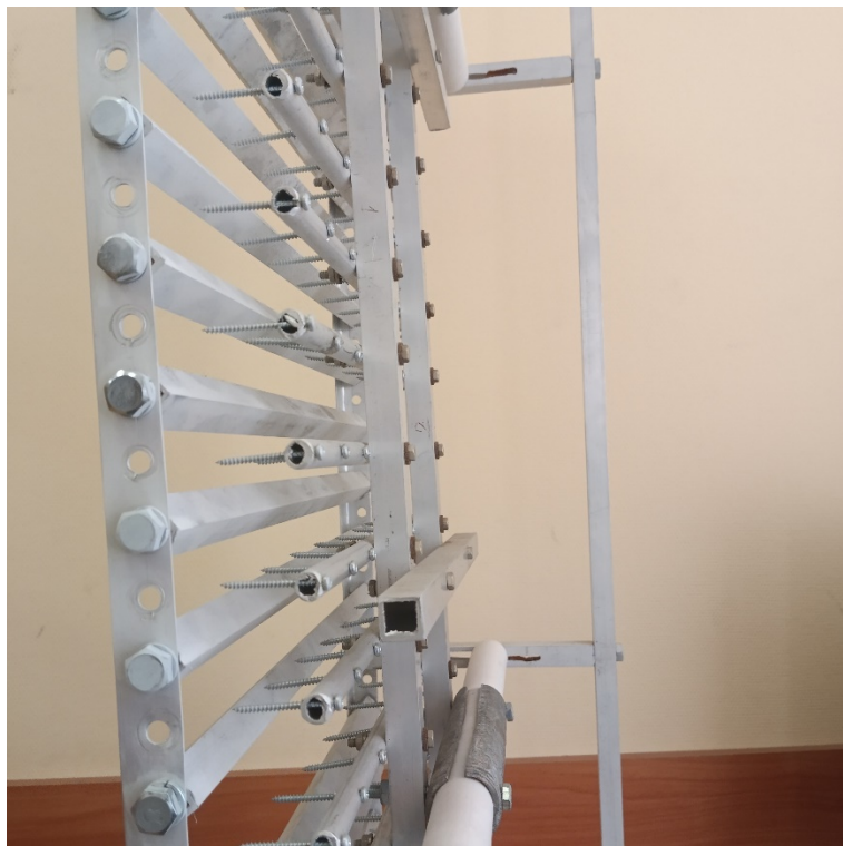
Рис. 5. Генератор ионного ветра, общий вид (слева) и с зажжённой короной (справа)
