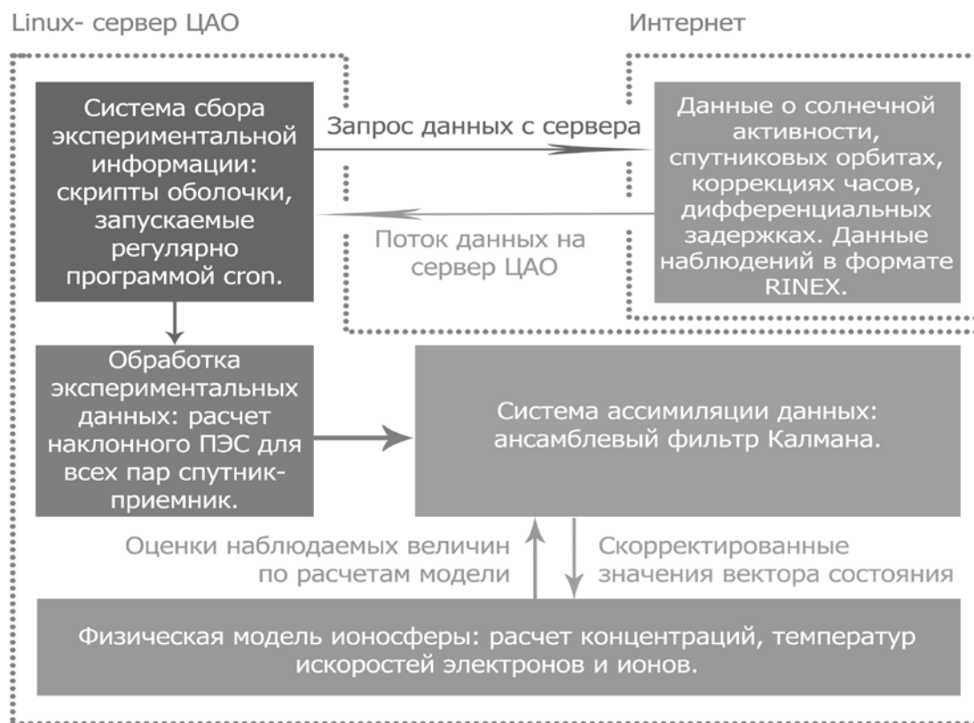
Рис. 2. Структурная схема потоков данных в разработанной модели ионосферы.
